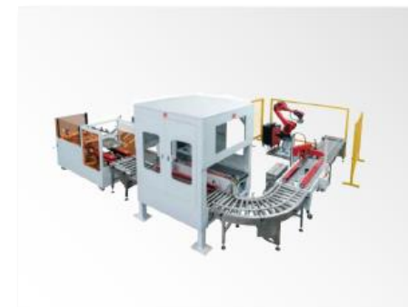
开装码生产线
