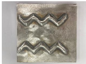
等离子熔覆层宏观形貌
