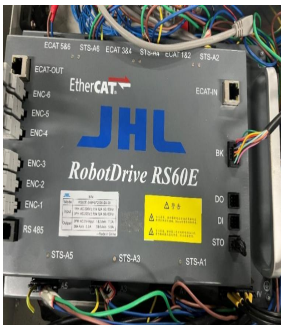
图1 伺服驱动器原型样机
