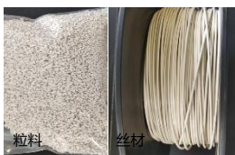
图1 PEEK基粒料和丝材
