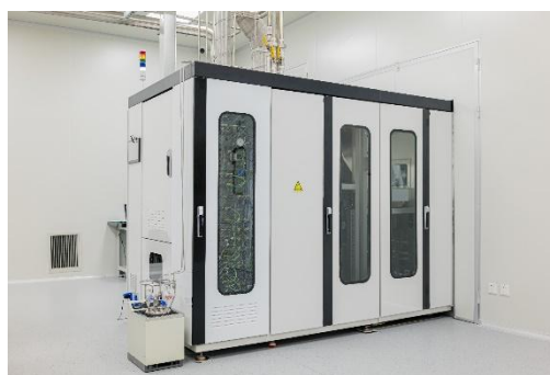
图2 SiC高温外延生长装备 (背面)
