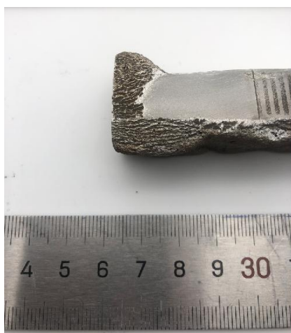
图1 新型铝合金高温灼烧后的空泡化组织
