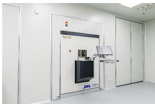
图1 SiC高温外延生长装备 (正面)
