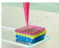
图1 三喷头复合材料打印
