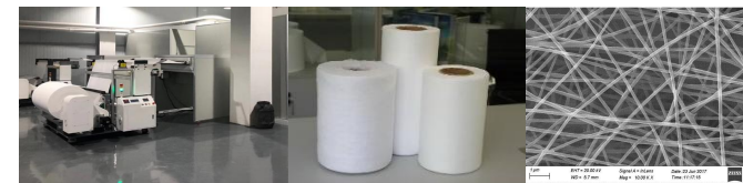
纳米纤维口罩滤膜及生产线
