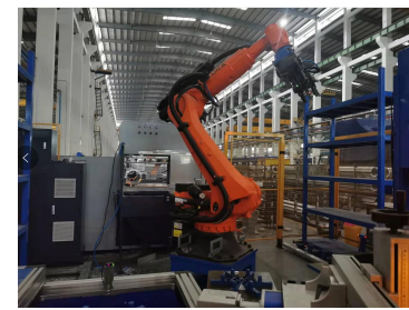
新能源汽车电机壳产线
